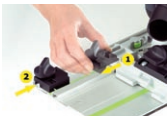
Takaiskujarru on helppo ottaa esiin ja asettaa ohjainkiskolle.
