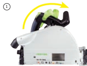
1. Avaat vain FastFix vivun ja painat konetta alaspäin kuin sahanterää upottaessasi, kunnes se kuultavasti lukittuu. Karalukko on aktivoitu.
