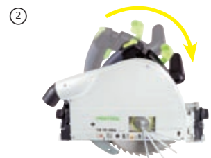
2. Kätesi ovat nyt vapaat. Kierrät ruuvin koloavaimella auki ja irrotat sahanterän.
